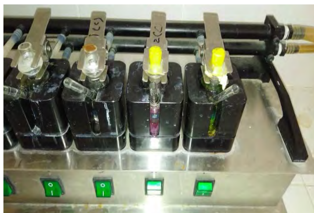
Figure 3.15 Franz Diffusion Cell apparatus
